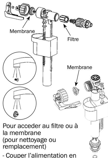
Pour accéder au filtre ou à la membrane (pour nettoyage ou remplacement)
